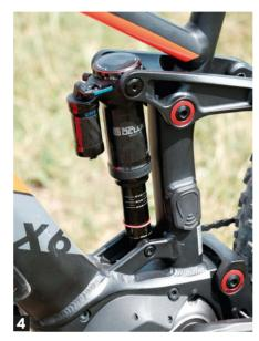
**CAMBIO AL TOP** IL CAMBIO È A 12 RAPPORTI, CON **DERAGLIATORE SHIMANO** DEORE XT [1], PRECISO E ROBUSTO. I COMANDI A MANUBRIO [2] SONO SHIMANO SLX CON LA LEVA DELLA SCALATA CHE FUNZIONA IN ENTRAMBI I SENSI: È AZIONABILE SIA CON IL POLLICE, SIA CON L'INDICE. LE SOSPENSIONI SONO ROCK SHOX, CON FORCELLA REGOLABILE NELL'IDRAULICA IN ESTENSIONE **[31** E COSÌ PURE IL MONOAMMORTIZZATORE [4] DI TIPO TRUNNION E CON LEVETTA PER LO BLOCCAGGIO RAPIDO.
